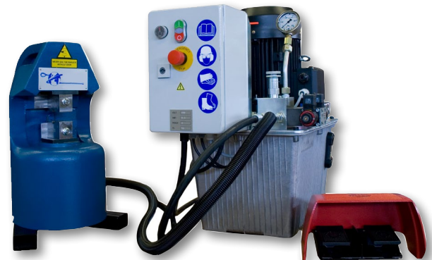
75 тонный пресс с гидравлической станцией
