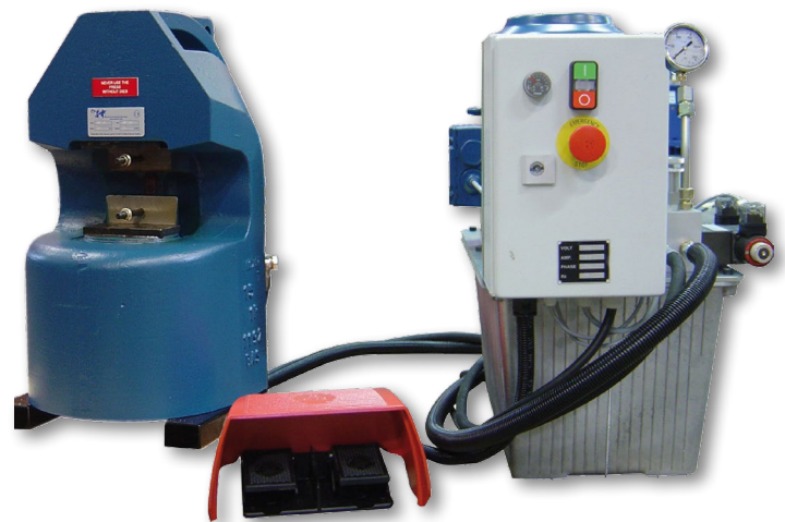
150 тонный пресс с гидравлической станцией
